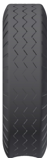
Falta de pressão
